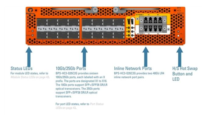
Figure 12: BPS-HC3-Q35C2G Module
